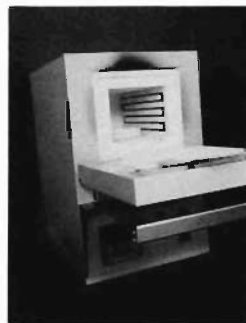
写真4 破裂板の加熱処理状況
