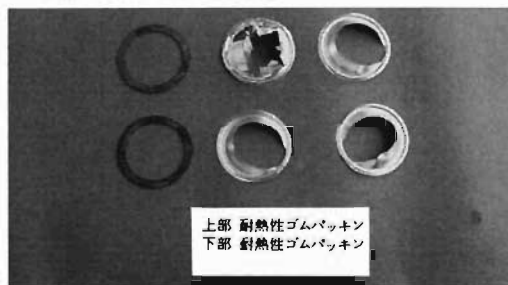
写真3 破裂板の破裂状況
