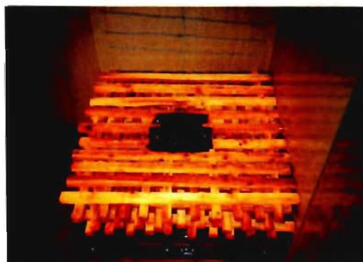
写真7 クリブ火災実験(燃焼後の状況)
