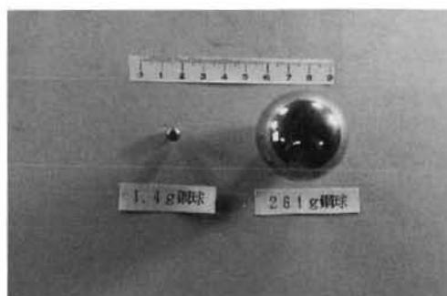
写真3 判定及び確認試験に用いる鋼球
