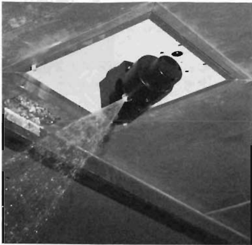
写真1 自動指向散水装置（試作1）
