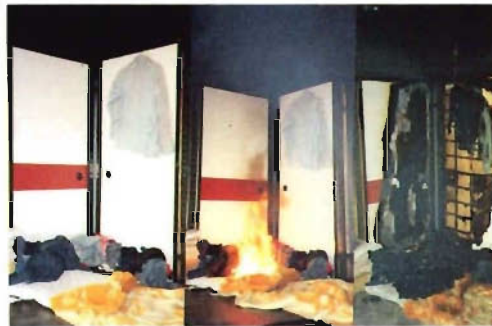
写真7 居室を想定した消火実験(実験No.8)
