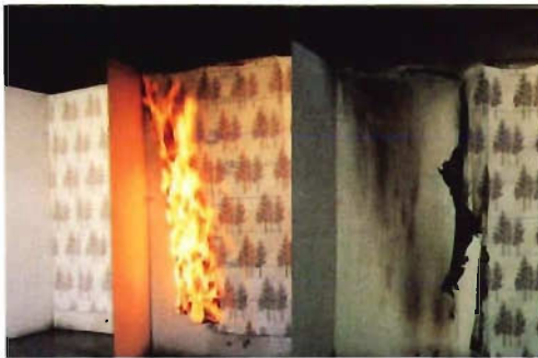
写真6 カーテンの消火実験(実験No.6)
