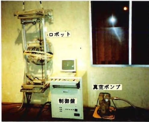
写真1 ロボットの構成
