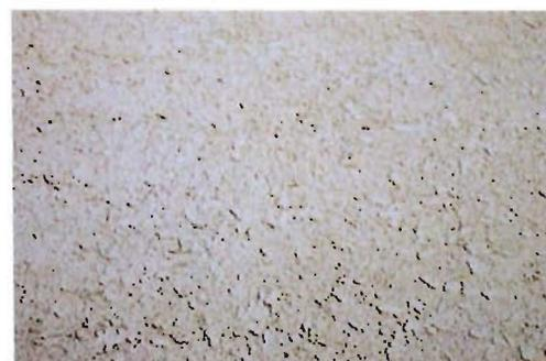
写真7 供試吹きつけ壁 (凹凸1~2mm)
