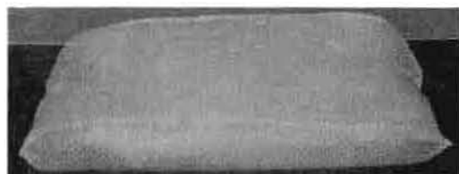
写真5 試験体Aの水道水吸水1分経過後
