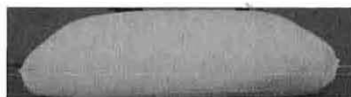
写真 15 試験体 C の水道水最大吸水形状
