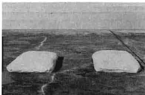
写真31 試験体Cの太陽光曝露状況 (左がCaCl 2 処理)
