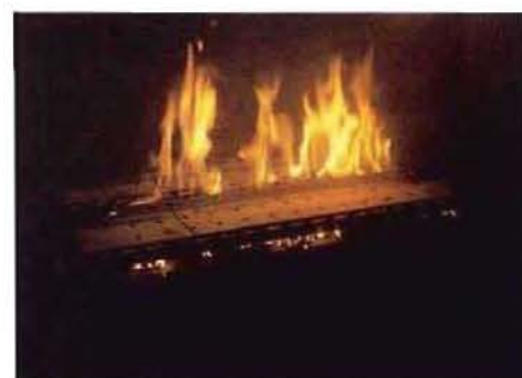
写真 3-1 I B 畳の燃焼状況
