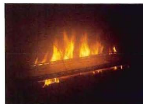
写真 4-1 F P S 三層畳の燃焼状況
