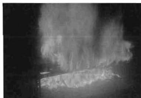
写真6-1 FPS畳の燃焼状況
