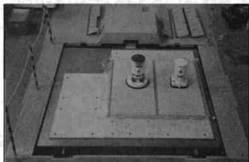
写真 二次元振動試験機を使用しての灯油ストーブの挙動実験
