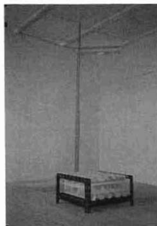
写真6 第2消火実験の燃焼材の状態
