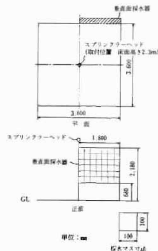
図4 垂直面散水分布測定図
