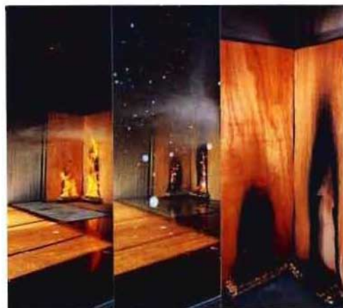
写真7 A型ヘッドによる第1消火実験
