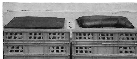
写真2 吸水1分後の状況
