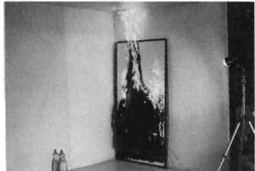
写真8 襖（ダンボール紙製）の燃焼状況
