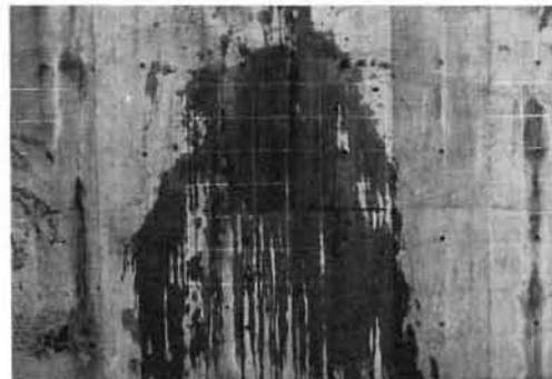
写真14 牛乳パックで2mの距離からの散布状況
