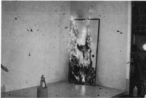
写真9 襖（木枠組製）の燃焼状況
