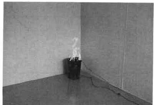
写真6 クズカゴ(金属製)の燃焼状況
