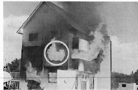
写真7 二階居室F・O発生後（開口部のガラスが落下すると同時に火炎が噴出している状況）
