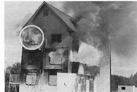
写真9 三階居室のF・O発生後の状況（写真4～9は、つくば火災実験）
