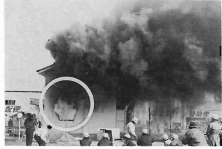
写真3 F・O発生に伴う火炎の噴出状況（潮見・第二実験）
