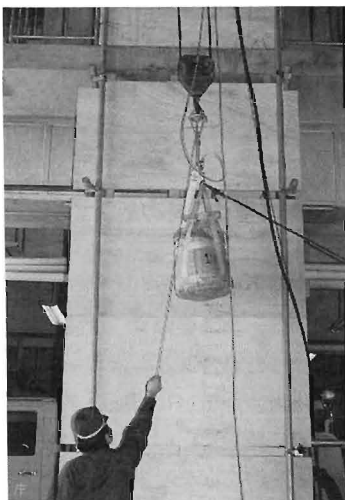
写真6 落下時の動ひずみ測定状況
