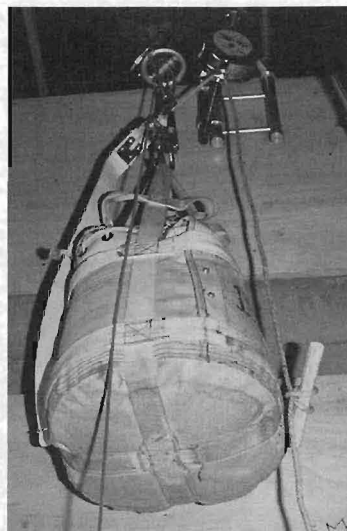
写真5 降下急停止時の動ひずみ測定状況
