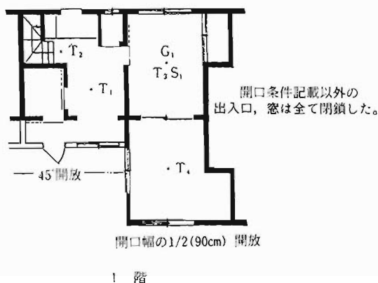
図3 開口条件及び測定点設置状況
