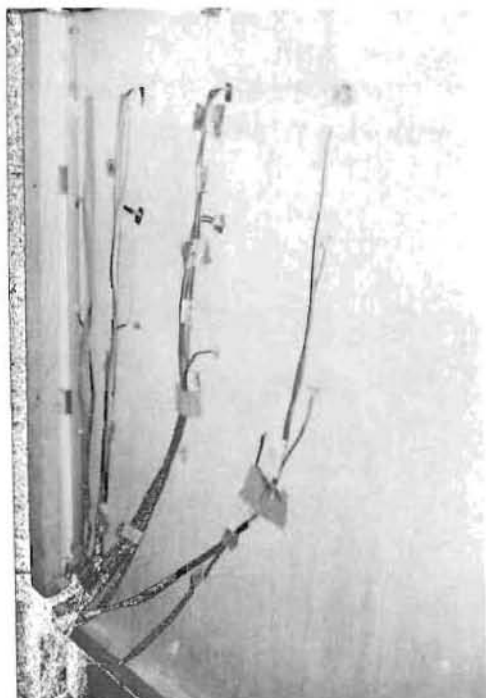
写真3 熱電対による壁体各部の温度測定
