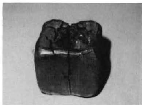
写真6 角材の炭化状況 (9cm角, 雰囲気170°C, 72時間加熱)
