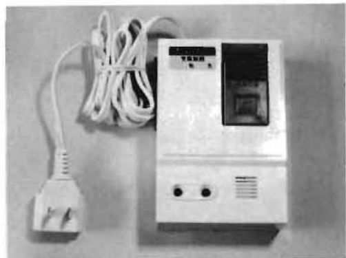
写真2 LPガス用ガス漏れ警報器
