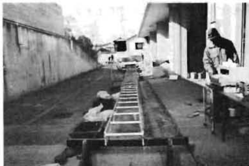
写真2 鋼管製三連はしごのひずみ測定
