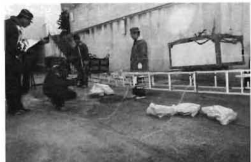
写真3 鋼管製三連はしごのたわみ測定
