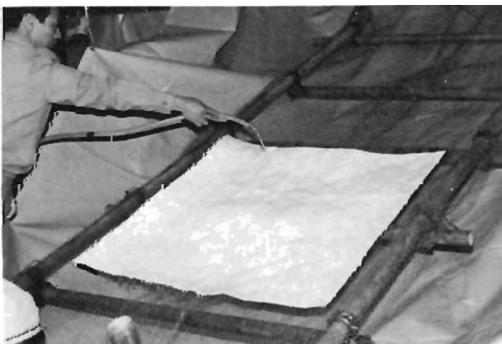
写真3 吸水マットの吸水性能試験
