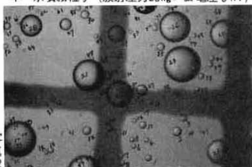
単一水噴霧粒子 (放射圧力 20 \text{ kg/cm}^2 電圧 0 \text{ kV} )
