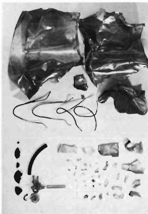
写真3 一斗缶、ホーローピーカー及びバーナーの破損状況
