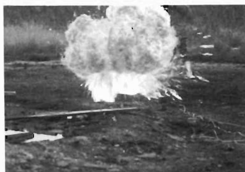
写真4 無水クロム酸との混触(火源なし)
