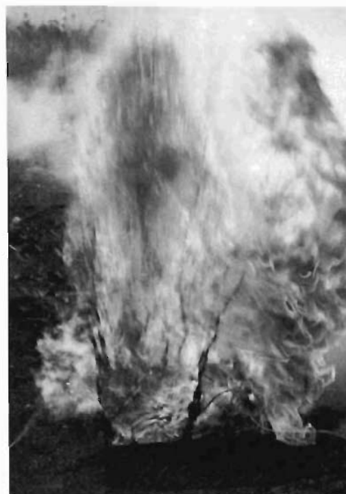
写真5 クロム酸ナトリウムとの混触(火源有り)
