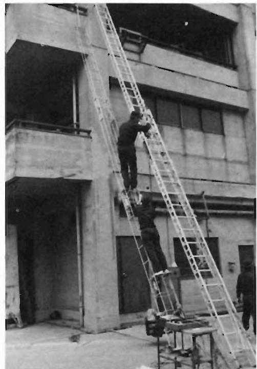
写真5 たわみ及びひずみ測定状況（75度架てい）
