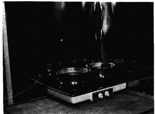
写真2 ステンレス板張壁体
