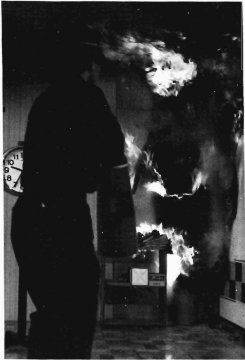
写真3 天井約1㎡に着火した時点で消火開始
