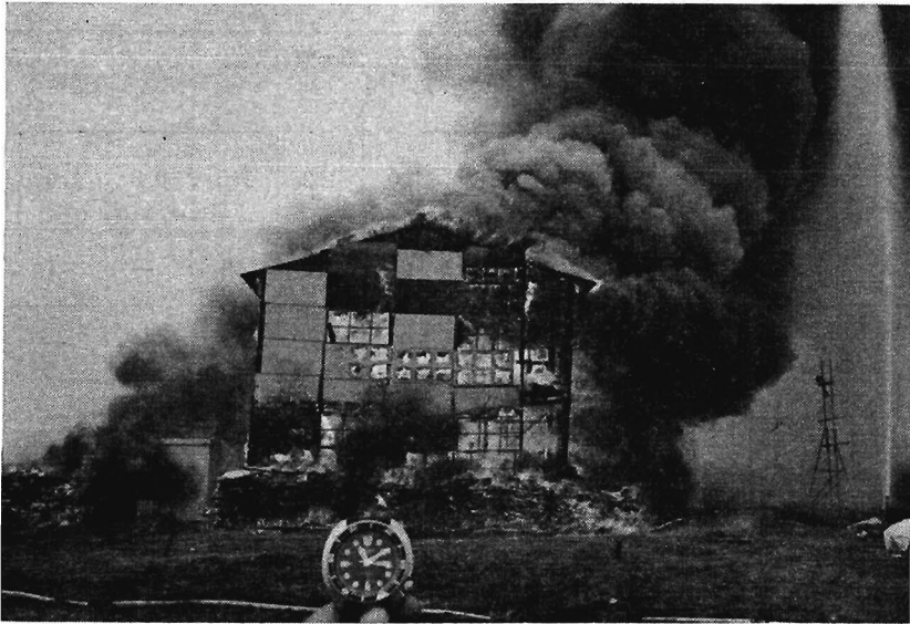
写真3 実規模火災における熱遮断実験
