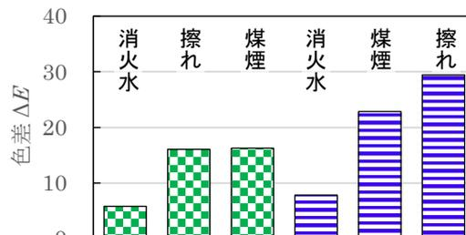
図18 撥水剤による放水を利用した除染への影響比較(撥水剤無 : 、有 : )
