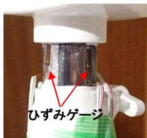
図5 ひずみゲージの貼付け
