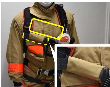
写真1 生地片サンプルの取付け状況
