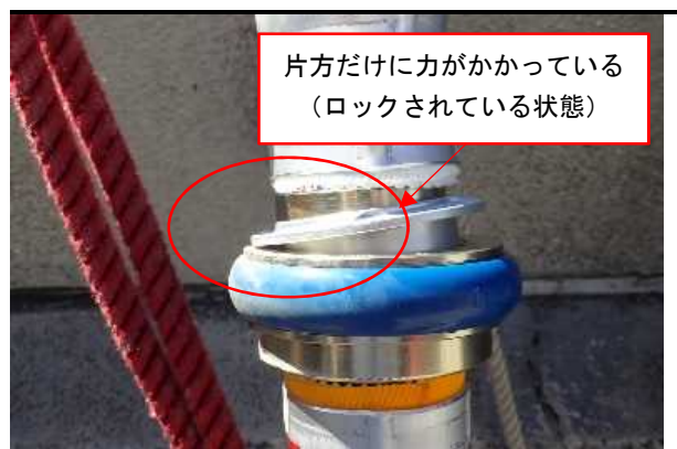
図2 実験後の結合金具
