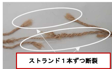
写真7 未使用引綱の断裂状況
