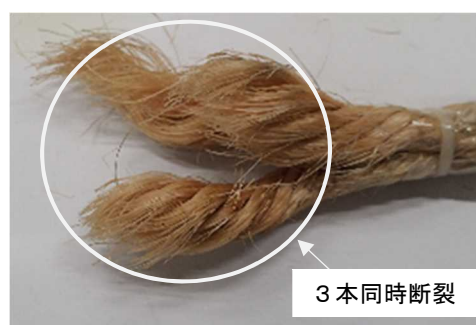
写真2 断裂引綱の部分
