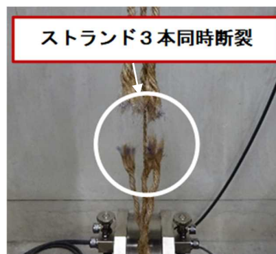
写真6 希硫酸引綱の断裂状況
