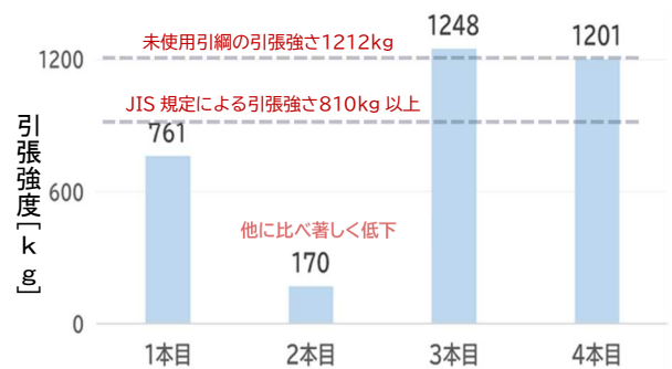
図1 断裂引綱の引張強度
