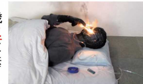
たばこの火源が鼻カニューレに着火する検証実験の状況
