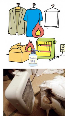
電気ストーブに布団が接触し焼損した状況
