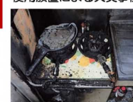
調理中の鍋が空焚きになったことで火災となった。火が上がっていても消火器があれば延焼拡大を防ぐことができる。
