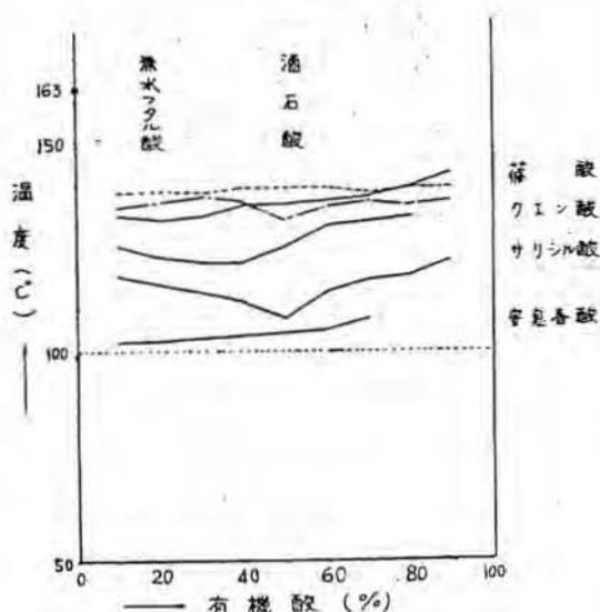
分解点163°Cの亜塩素酸ナトリウムは有機酸の添加により全面的に発火点が下がり、特にサリシル酸
