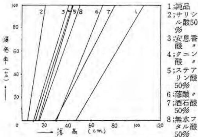
また、概して発火点の低いものは落槌感度も鋭敏となっている。この実験は24時間以上試料をデシケータ中に保管後、落槌試験を行ったもので、空気中に放置したものは空気中の水分を吸収するため第2表の実験値よりは、さらに鋭敏なる数値を示めた。
