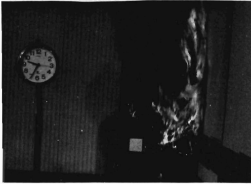
写真2 部屋の隅角部に点火し壁体ふすまに火が立上った状況
