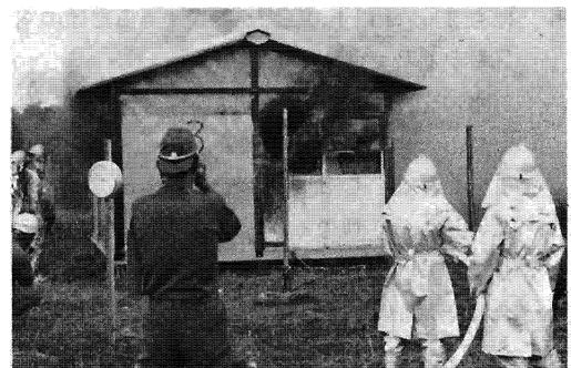
写真8 D-1級ポンプで1分30秒放水 ほぼ鎮圧した状況
