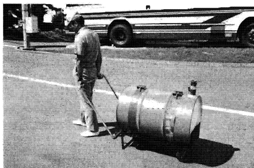
写真3 移動式簡易貯水槽
