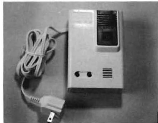
写真1 都市ガス用ガス漏れ警報器
