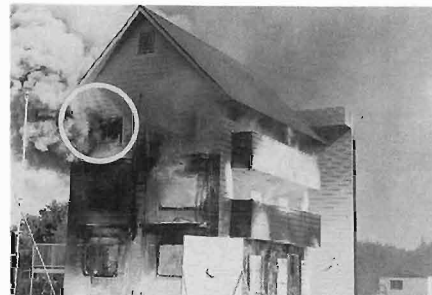
写真8 三階居室F・O発生前（開口部から褐色の煙が大量に噴出している状況）
