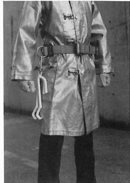
写真7 携帯用リングにカラビナを取付けた状況
