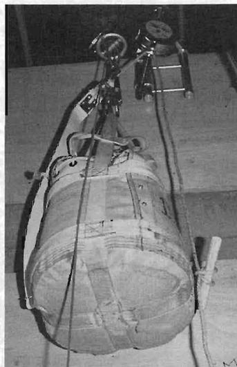
写真5 降下急停止時の動ひずみ測定状況
