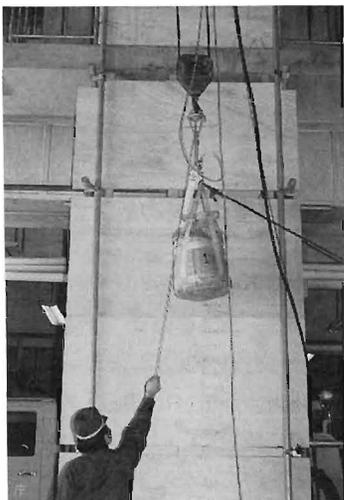
写真6 落下時の動ひずみ測定状況
