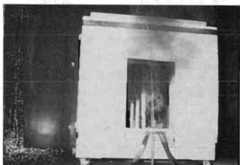
写真6 図10の燃焼状況 (F・O発生31秒前)
