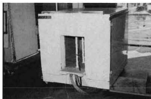
写真1 模型燃焼室の外観
