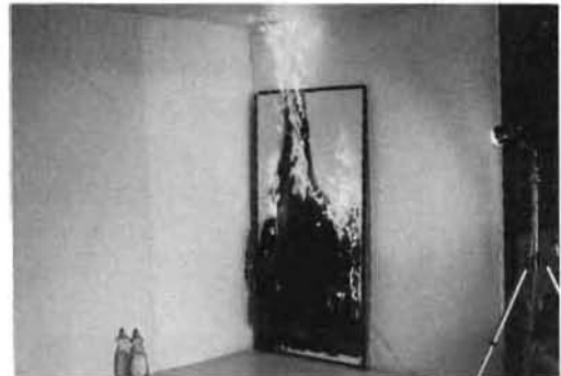
写真8 襖（ダンボール紙製）の燃焼状況
