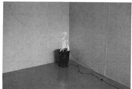
写真6 クズカゴ(金属製)の燃焼状況
