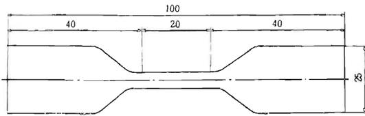
図1 ダンベル3号形(単位mm)
