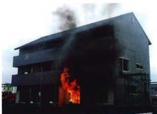
火災室のフラッシュオーバー後の炎の状況
