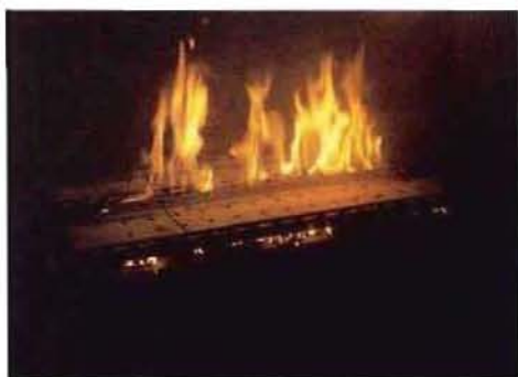
写真3-1 IB畳の燃焼状況
