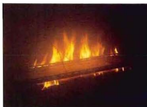
写真4-1 FPS三層畳の燃焼状況
