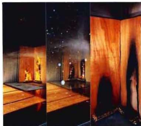
写真7 A型ヘッドによる第1消火実験
