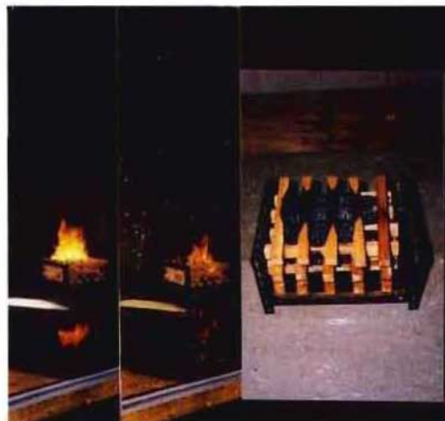
写真8 A型ヘッドによる第2消火実験
