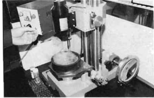
写真5 塩素酸カリウムの落球式打撃感度試験
