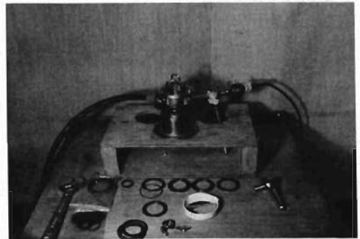
写真5 破裂板の破裂圧力測定状況
