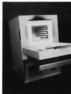
写真4 破裂板の加熱処理状況
