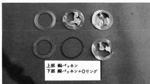
写真2 破裂板の破裂状況
