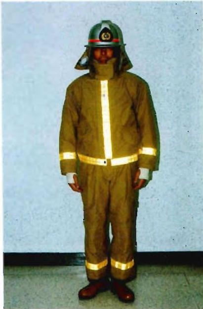
写真1-1 試作上下式防火服A型
