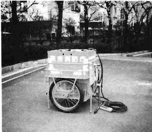
写真7-2 昇降バケットを収納した状況
