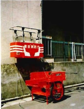
写真3 昇降バケットの実用機
