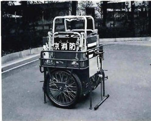
写真4 昇降バケット収納状態
