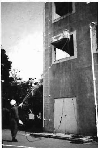
写真2 昇降バケットの試作機
