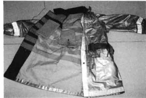
写真6 温度センサーの取付状況 (収納袋)
