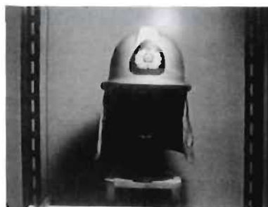
写真9 試験用人頭+新型しころ
