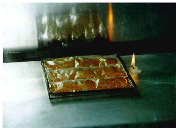
写真9 油吸収マットの引火抑止試験の状況
