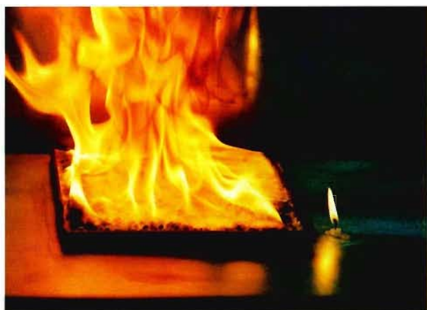
写真8 パーライトの引火抑止試験の状況
