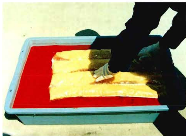
写真5 油吸収マットの投入状況
